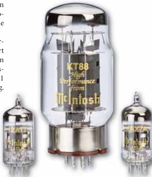
Die klassische Endstufe setzt bis heute auf gängige Röhrentypen à la 12AT7, 12AX7 und natürlich die Endröhre KT88
