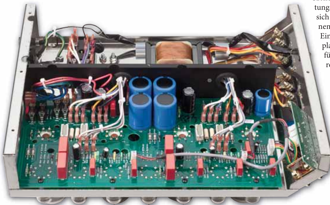
Früher war alles anders: In Endverstärkern etwa wurde munter kreuz und quer frei verdrahtet – auch in der ursprünglichen 275. Heute werden – aus gutem Grund – bei komplexeren Aufbauten Platinen eingesetzt. Die in der Reinkarnation der 275 verarbeiteten Bauteile sind ausgesprochen hochwertig
