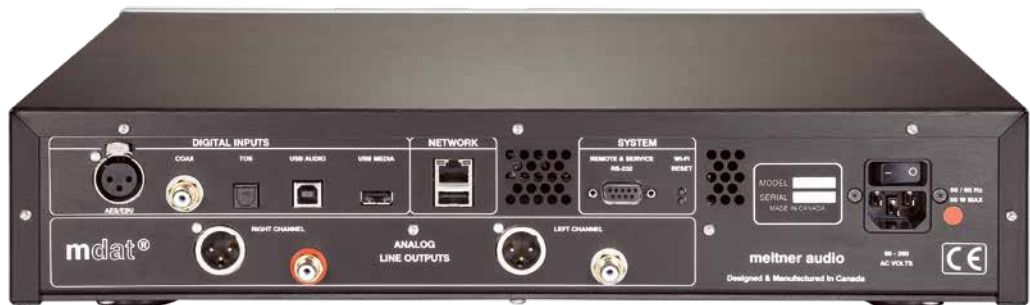
Der MA3 bietet die üblichen Digitaleingänge, dazu eine LAN-Buchse und USB-Schnittstellen für PC/Mac sowie externe Speichermedien. Analogausgänge in Cinch und XLR.
