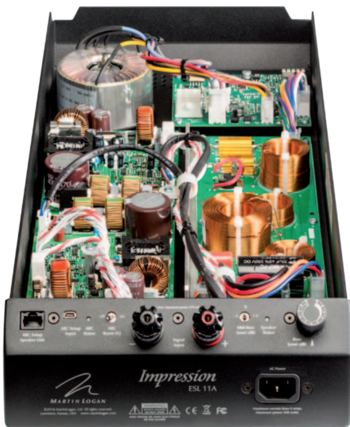
Die gesamte Elektronik sitzt entkoppelt in einer Schublade im Sockel und umfasst unter anderem die Verstärkermodule für den Subwoofer, die Transformatoren für die Vorspannung der Elektrostaten.
