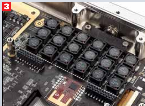
3 Da die flache Bauform des Amps keine großen Filterspulen zulässt, sieht eine ganze Phalanx kleinerer Exemplare hochfrequente Anteile aus der Versorgungsspannung
