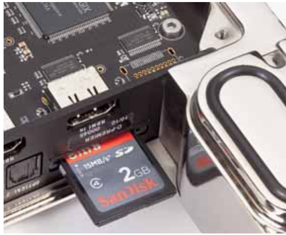
Seine Einstellungs- und Bedienoptionen erhält der D-Premier von einer SD-Karte, die in einem Schlitz auf der Rückseite steckt (l.). Die Elektronik in der Fernbedienung registriert sensibel jeden „Druck und Dreh“
