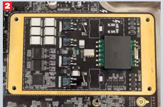
2 Das Schaltnetzteil steckt mit der aktiven Leistungsfaktor-Korrektur (PFC) in einem Modul. Devialet hat die Baugruppen so clever kombiniert, dass es dafür sogar ein Patent gab
