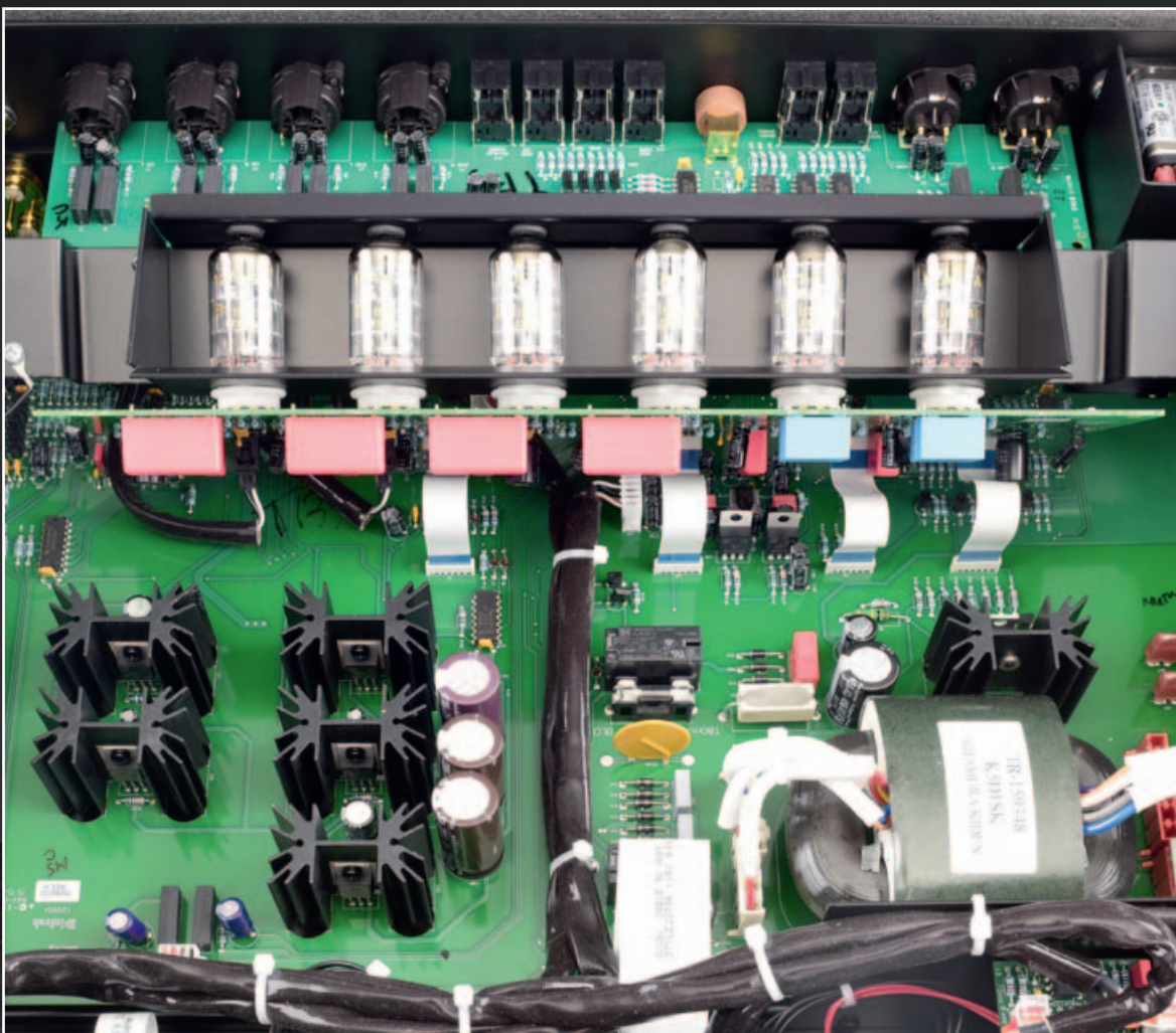
Der Röhrentrakt des McIntosh C22 sitzt dämpfend aufgehängt und etwas abgeschirmt quasi frei unter dem schwarzen Gehäusedeckel. Die clevere Fixierung oben am Pumpstutzen der Doppeltrioden stellt gleichzeitig eine Transportsicherung dar. Beim Einschalten werden die insgesamt sechs Röhren schonend langsam angeheizt.
