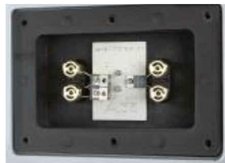
Hinter einer Metallabdeckung befinden sich austauschbare Bauteile, die – quasi als Lebensversicherung – die Chassis vor Überlastung schützen
