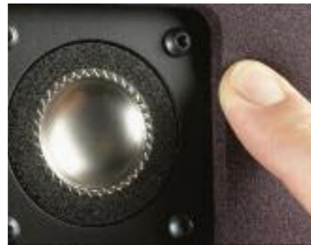
Nicht schön, aber sinnvoll ist die dicke Lage Schaumstoffs um die Chassis herum, die störende Reflexionen von der Schallwand stark vermindert
