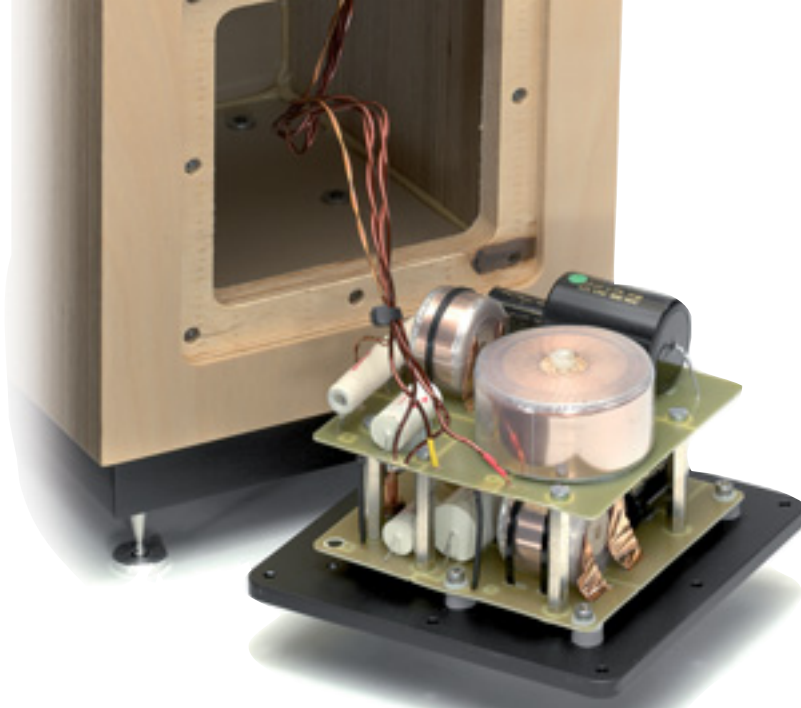
Made by Mundorf: Die Weiche wird bei Mundorf in Köln gefertigt und ist in einer eigenen Kammer untergebracht. Diverse Spikes und Pucks sind unbedingt ausprobierenwert
