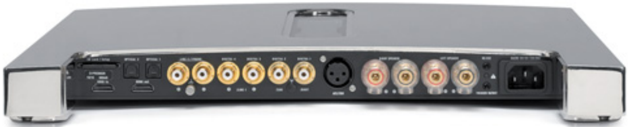
Normalerweise nicht zu sehen: Über dem Anschlussfeld sitzt in der Praxis eine Abdeckung
